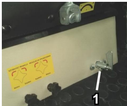
Rys. 4.2. Główny odłącznik prądu (1)
