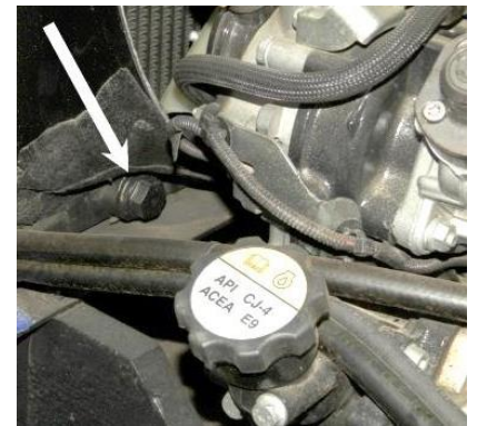
Rys. 5.3.7. Korek spustowy płynu chłodzącego z chłodnicy
