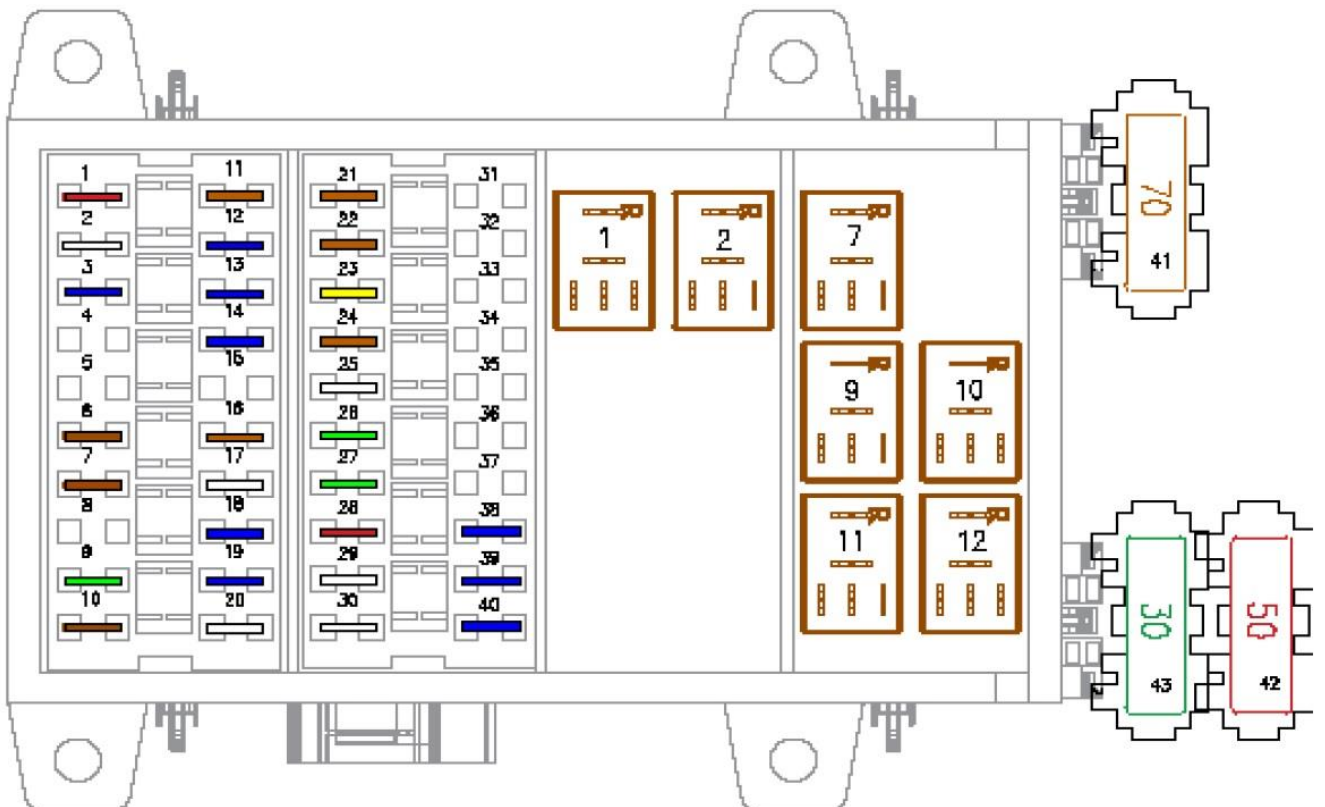
Rys. 5.4.3 Rozmieszczenie bezpieczników i przekaźników w skrzynce bezpieczników.
