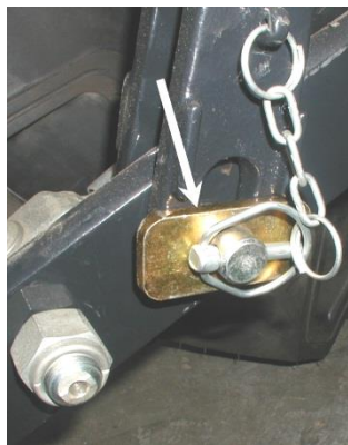
Rys. 4.6.3. Mocowanie wieszaków do cięgieł dolnych nieprzesuwnie - łeb i podkładka sworznia ustawione poziomo
