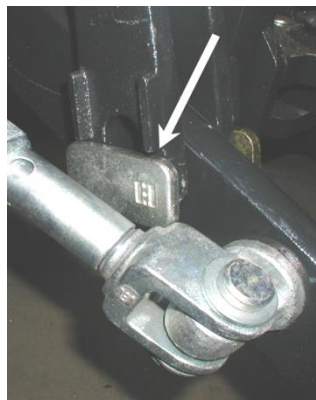
Rys. 4.6.3. Mocowanie wieszaków do cięgieł dolnych nieprzesuwnie - łeb i podkładka sworznia ustawione poziomo
