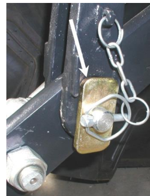
Rys. 4.6.4. Mocowanie wieszaków do cięgieł dolnych przesuwne - łeb i podkładka sworznia ustawione pionowo
