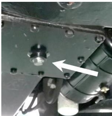
Rys. 5.9.1. Kork spustowy oleju przekładniowego
