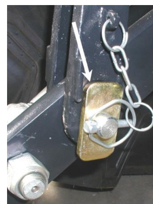
Rys. 4.6.4. Mocowanie wieszaków do cięgieł dolnych przesuwnie - łeb i podkładka sworznia ustawione pionowo
