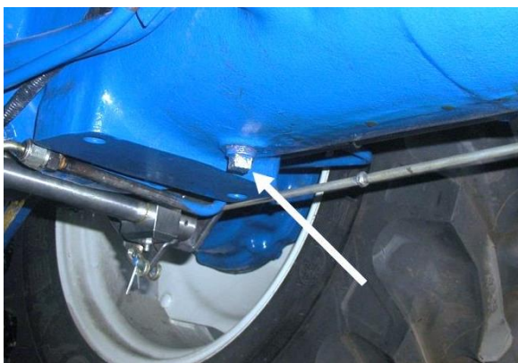
Rys. 5.9.2. Korek spustowy oleju ze skrzyni przekładniowej
