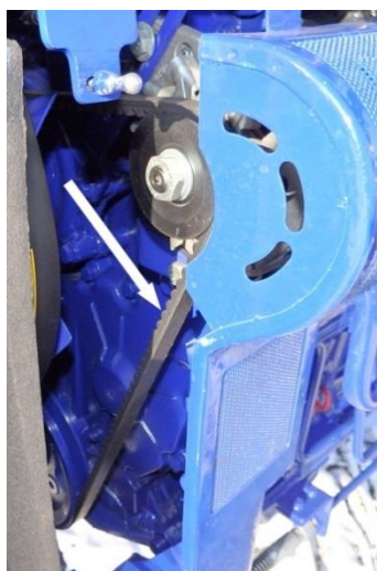
Rys. 5.4.1. Pasek klinowy napędu sprężarki.
