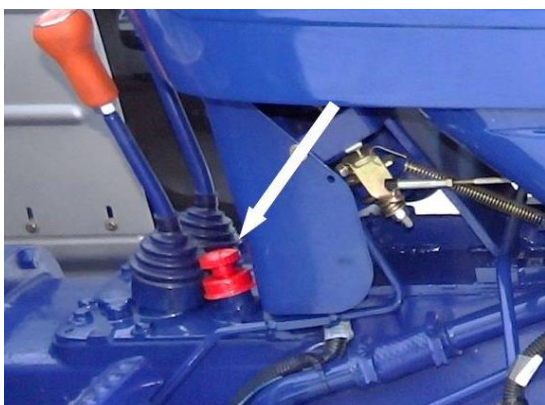
Rys. 5.9.6. Korek wlewu ze wskaźnikiem poziomu oleju skrzyni przekładniowej
