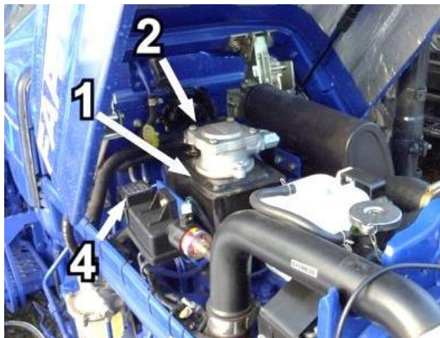
Rys. 5.5.1. Zbiorniki oleju hydrostatycznego: 1- zbiornik; 2- korek wlewu ze wskaźnikiem poziomu; 4- skrzynka bezpieczników.
