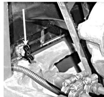
Rys. 5.3.7. Korek spustowy płynu chłodzącego z chłodnicy
