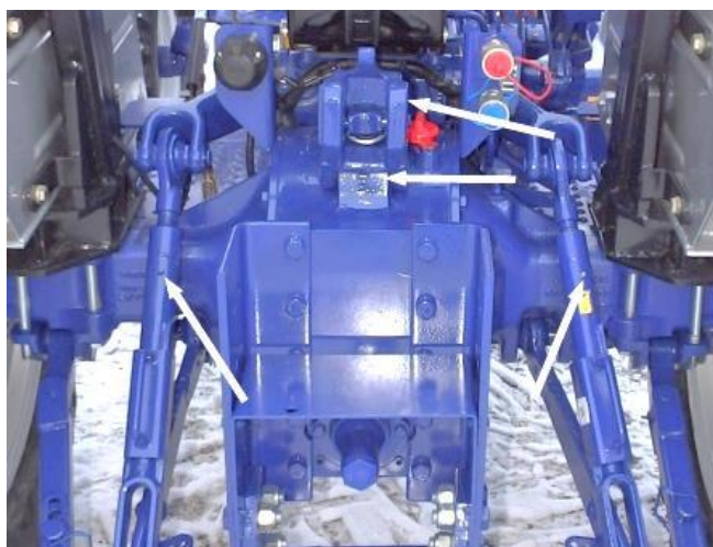
Rys. 5.10 Punkty smarowania TUZ.
