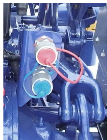
Rys. 4.5.2. Szybkozłącza układu hydrauliki zewnętrznej
