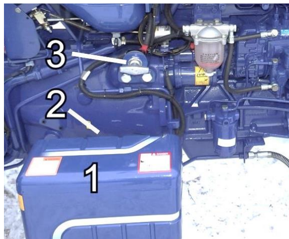
Rys. 5.4.3. Akumulator. 1- skrzynka akumulatora, 2- śruba mocowania pokrywy, 3- główny odłącznik zasilania
